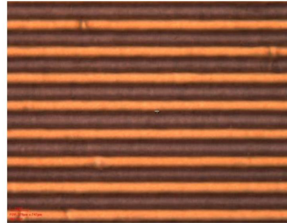
Fig. 3. 15 um L/S on M1 of 8ML panel
